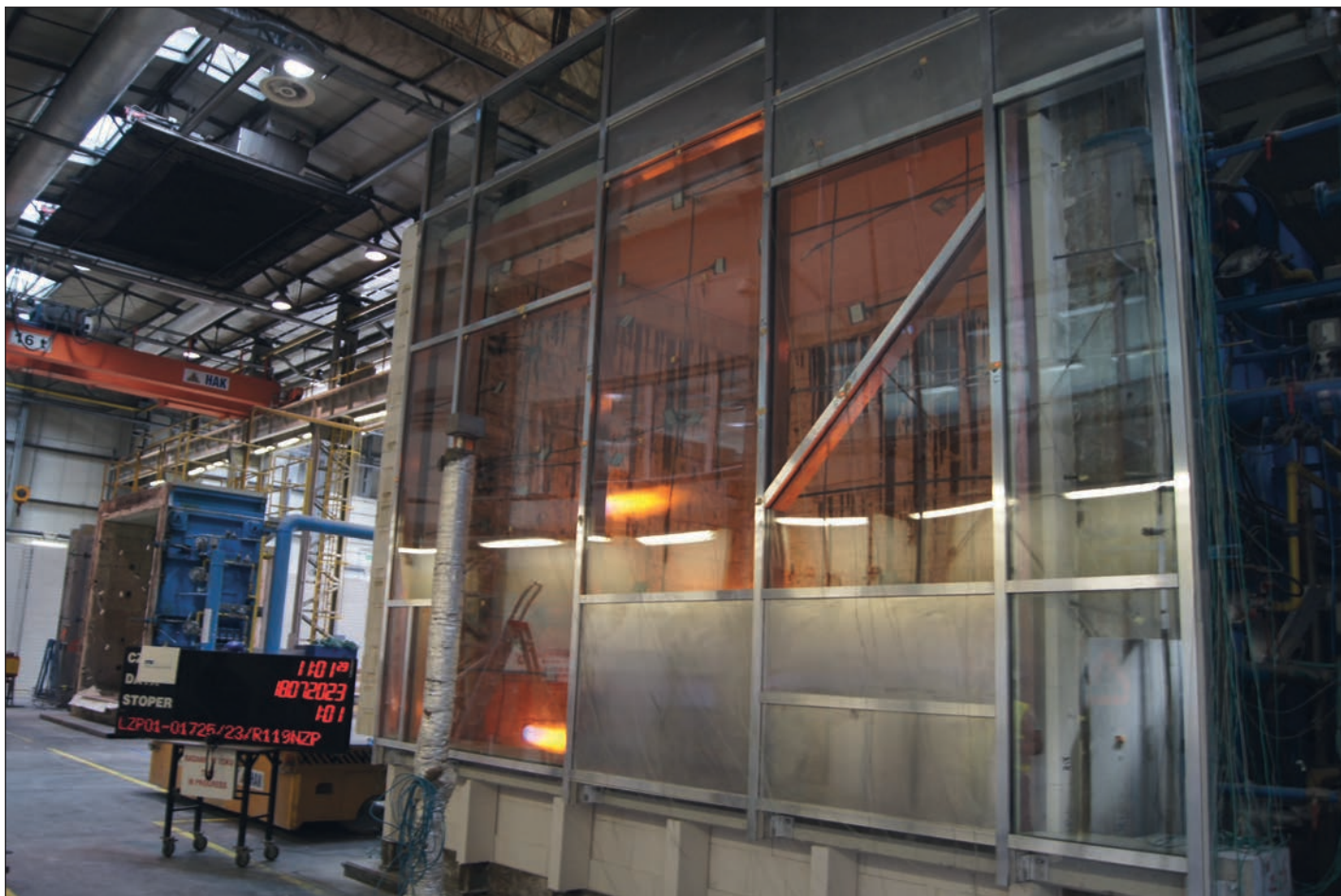
Fot.2. Przykładowy początek testu pożarowego ściany osłonowej w klasie EW
